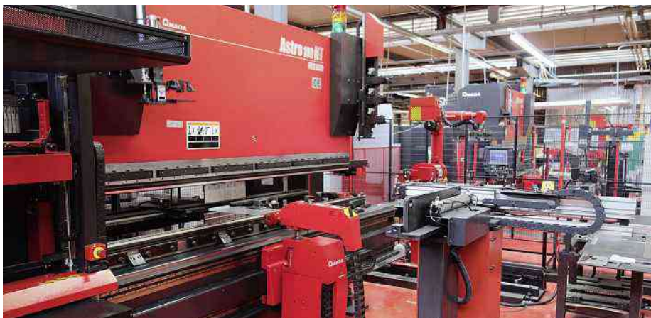
Auch neben der Fertigungslinie wird automatisiert gearbeitet. Im Bild: Amadas Astro 100, eine vollautomatisierte Biegeroboterzelle mit Werkzeugwechsler.
