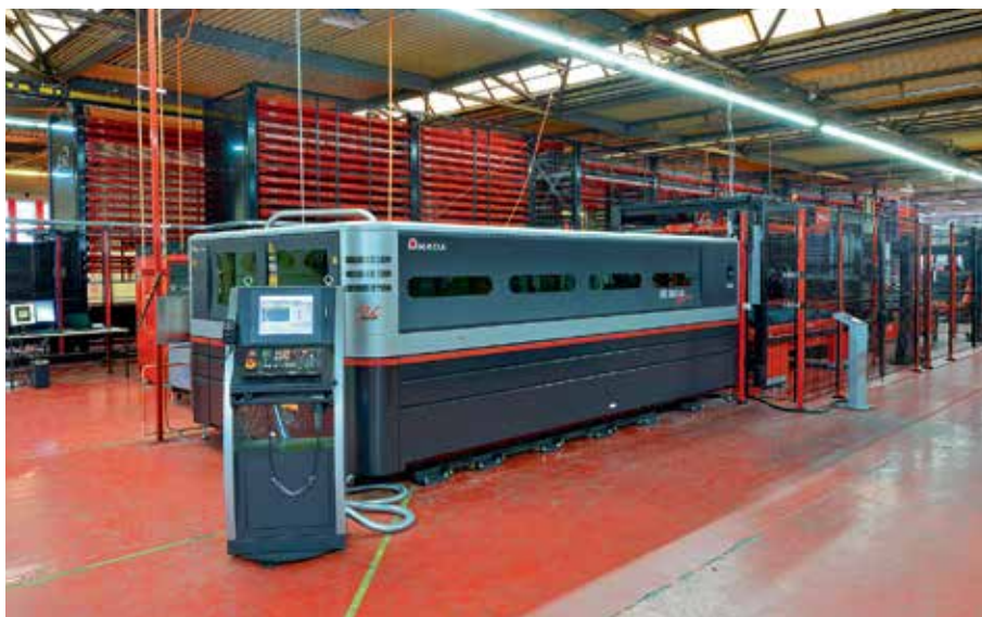
Innenansicht der Faserlaser-Schneidanlage «Amada FOL-AJ».
