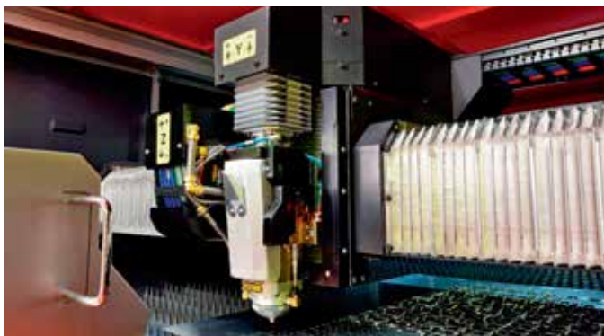
Innenansicht der Faserlaser-Schneidanlage «Amada FOL-AJ».
