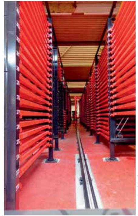
Magasin de stockage de tôles et de pièces découpées Amada CS300.
