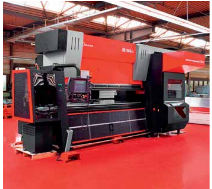
Presse plieuse avec chargeur automatique d'outils Amada HD-ATC.
