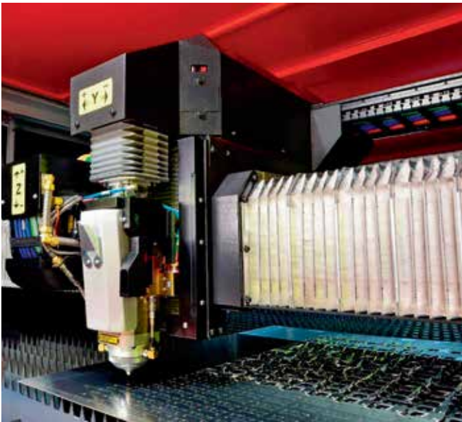
Laser fibre de découpe Amada FOL-AJ. (vue intérieure)
