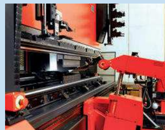
Robotisierte Abkantbiegezelle Amada Astro 100.
